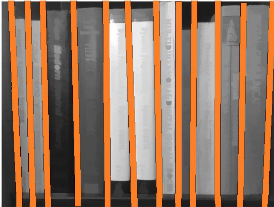
18. ábra: Az átméretezésen és morfológiai műveleteken átesett képen LSD módszerrel detektált élek
