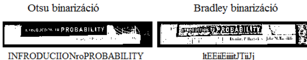
2. ábra Az egyes binarizációs algoritmusok eredménye, illetve az adott képen való szövegfelismerés eredménye
