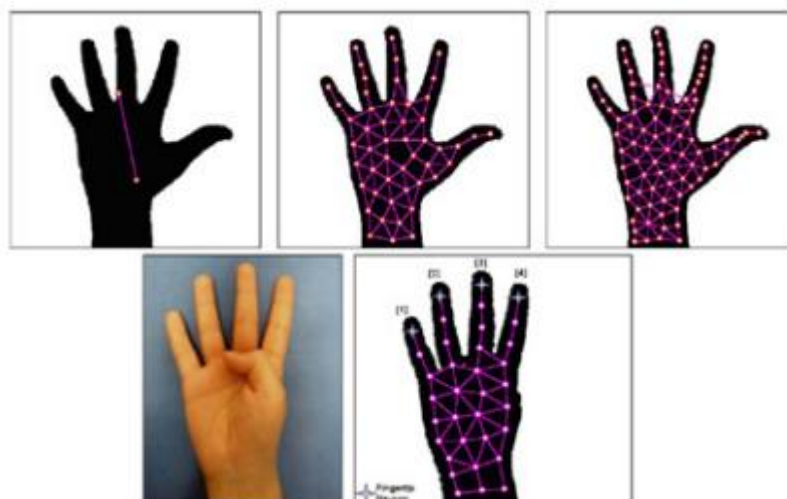
3.5 ábra: Self-Growing and Self-Organized Neural Gas network, egy egyre több neuronnal bíró, folyamatosan növekedő hálózat, mely azonban csak a kinyújtott ujjakat képes megszámolni (11)
