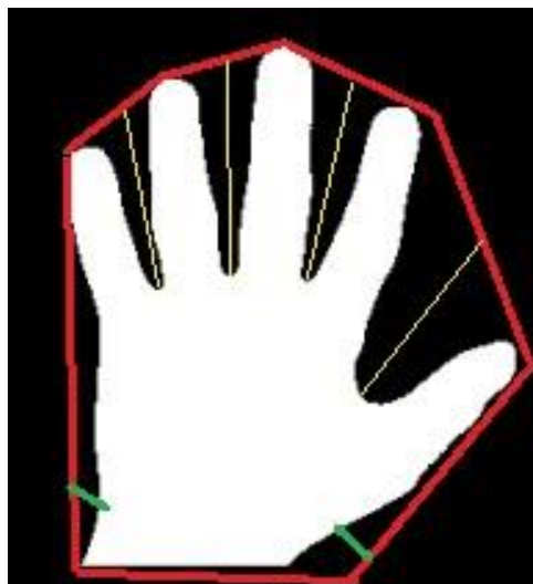
5.2 ábra: A kéz kontúrja a konvex burokkal és a konvex hibákkal. A sárga és zöld vonalak konvex hibákat jelölnek, a zöldek a csuklónál elhelyezkedő konvex hibák. (saját ábra)
