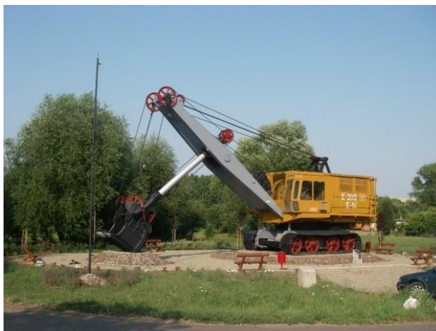
26. ábra UNEX E303 Mechanikus működésű hegybontó kotró (2014.11.01.), Forrás: http://www.geocaching.hu/caches.geo?id=4421 [34]
