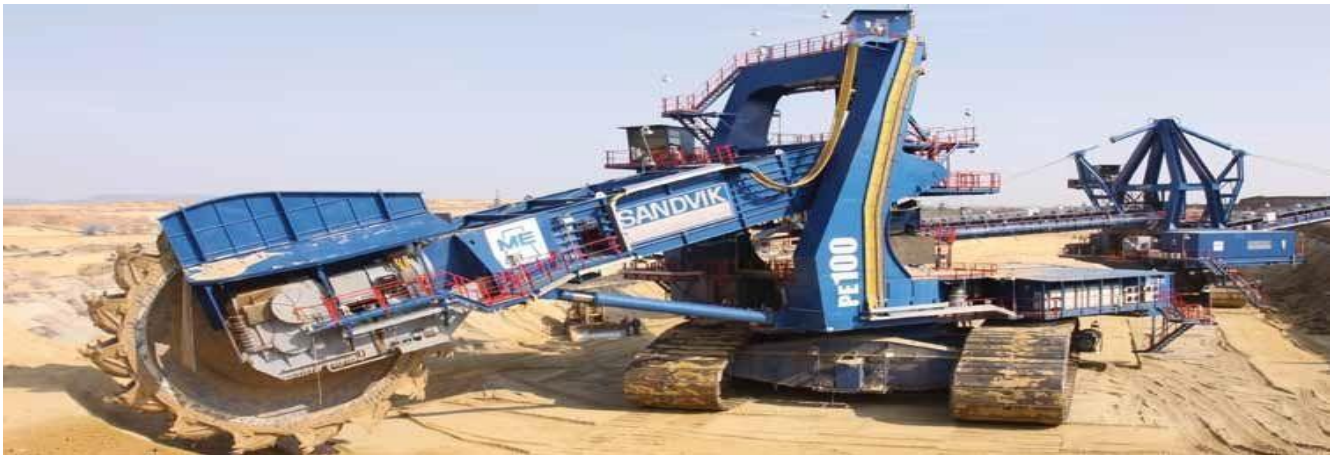
23. ábra PE 100-as kompakt kotró és PB 100-as szalagkocsi (2014.10.01.), Forrás: http://www.directindustry.com/prod/sandvik-mining/bucket-wheel-excavators-40142-354732.html [31]
