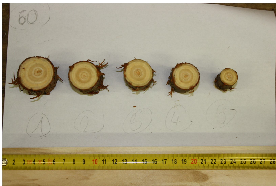
13. ábra Minták méretarányos fotózása kéreg-fatest arány megállapításához
