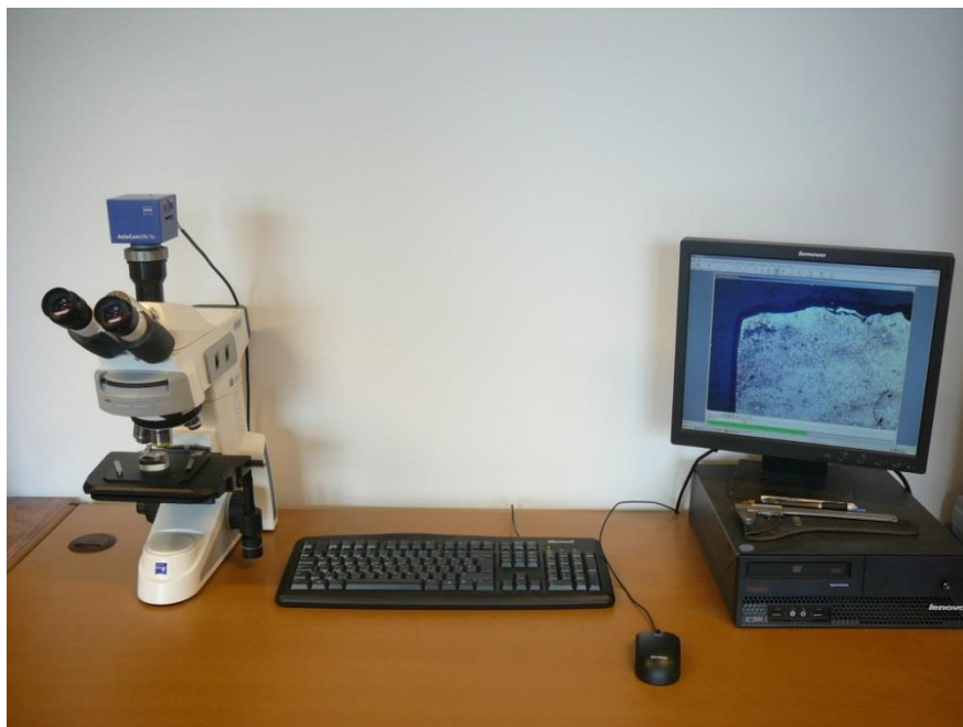
6.1. ábra. A Zeiss Axio A1 fémmikroszkóp (saját felvétel)
