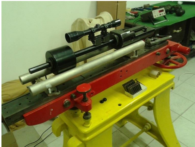
2.1. ábra. A mérőcső irányzékkal, lengéscsillapító súllyal állványon (saját felvétel)
