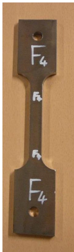
4.6. ábra. Az E modulus mérésére használt próbatest (saját felvétel)
