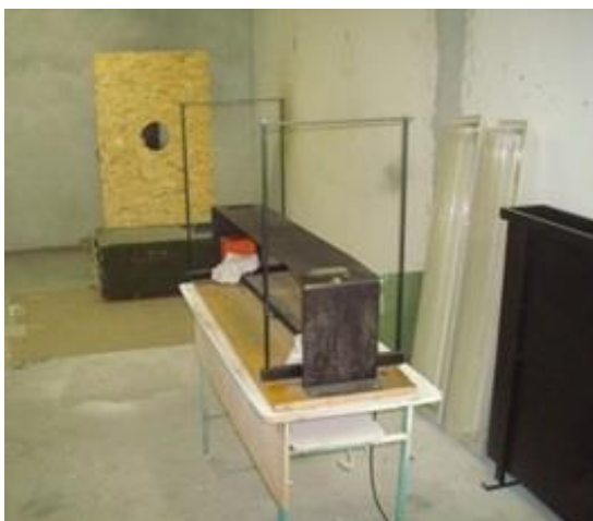
2.4. ábra. A sebességmérő eszköz (háttérben a védőpalánk)(saját felvétel)
