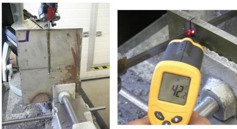
5.5. ábra. Fűrészelés és hőmérséklet ellenőrzés (saját felvétel)
