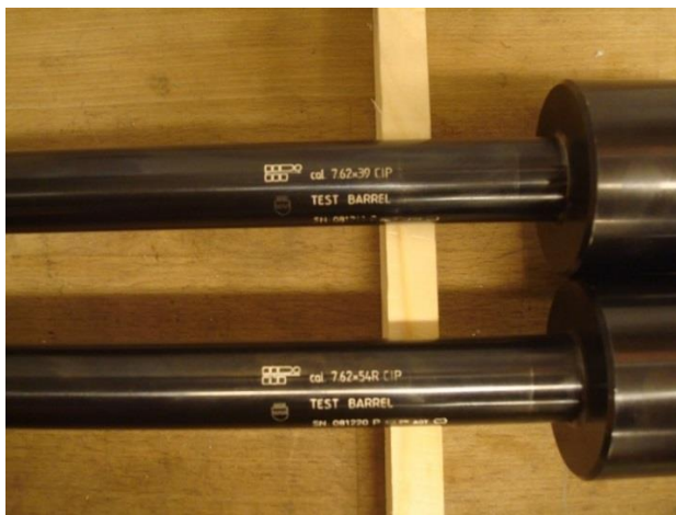
2.3. ábra. A vizsgálócsövek méretjelzései (saját felvétel)
