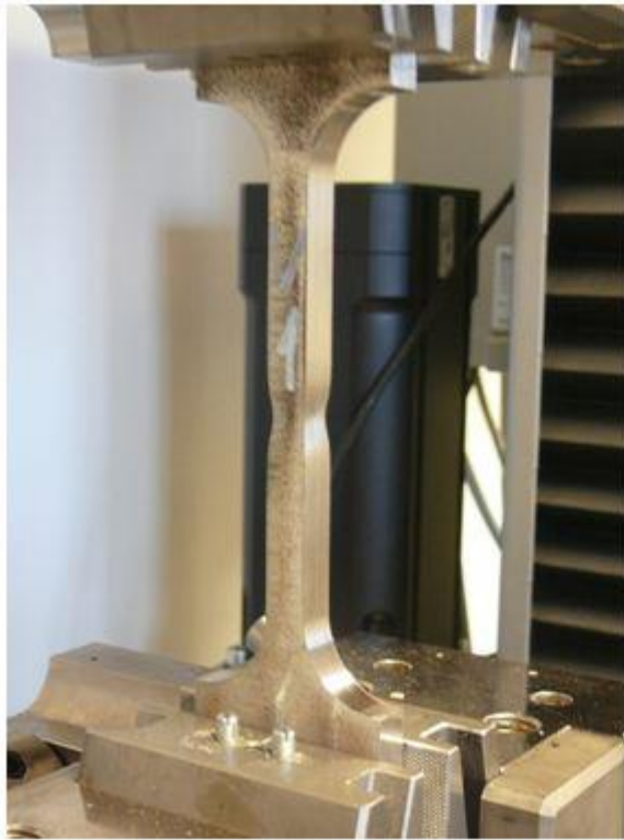
4.9. ábra. Az F1 és F3 próbatestek tönkremenetele (saját felvétel)
