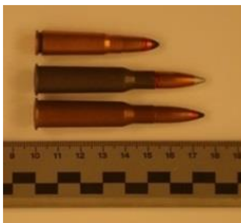
2.6. ábra. A felhasznált lőszer típusok (fentről lefelé: Bz, Lpsz, B32) (saját felvétel)
