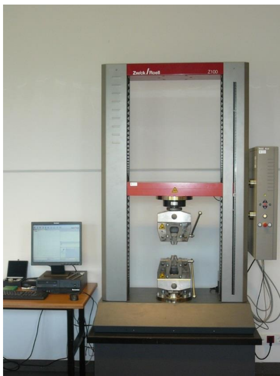
4.1. ábra. A Zwick Roell Z100 anyagvizsgáló gép (saját felvétel)
