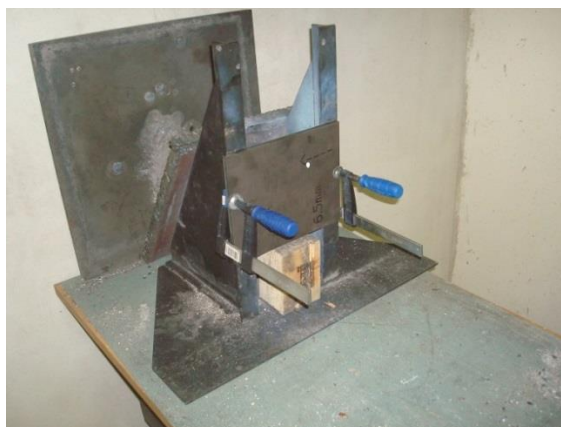
2.5. ábra. A céltárgy rögzítése (saját felvétel)
