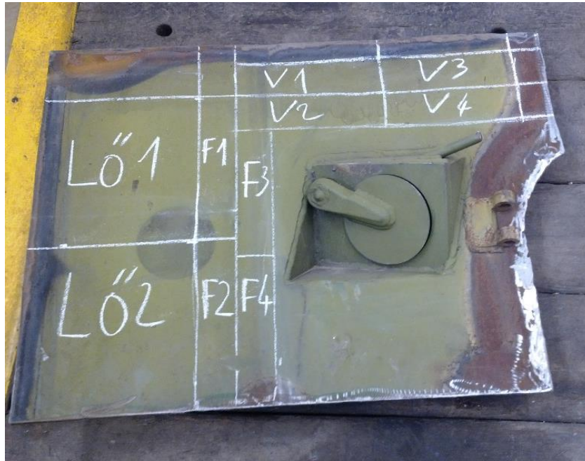
4.3. ábra. A vizsgált páncéldarabon bejelölve a próbatestek helye
