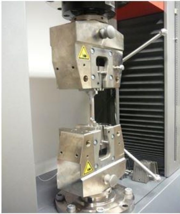
4.7. ábra. A próbatestek befogása (saját felvétel)
