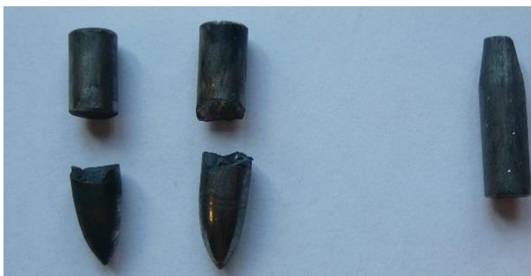
4.18. ábra. Vizsgált lőszermagok (balról jobbra: BZ, B32, LPSZ)
