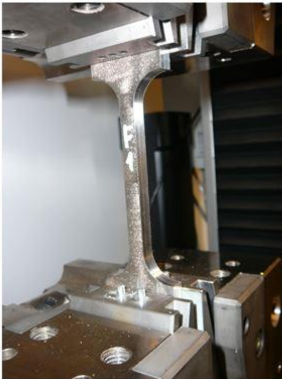
4.8. ábra. Az F1 és V1 próbatestek szakítás közben (saját felvétel)
