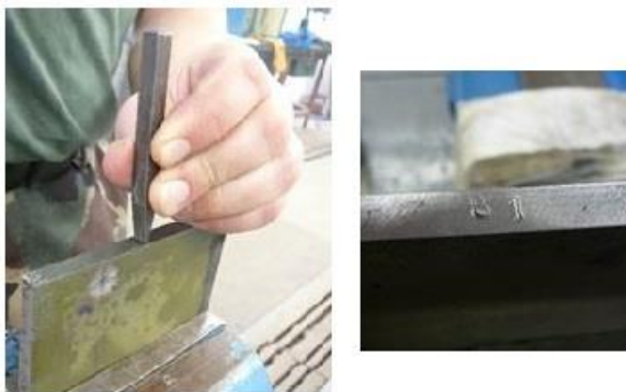
5.6. ábra. Mintadarabok jelölése (8-as számú lövés 1. nézet) (Saját felvétel)
