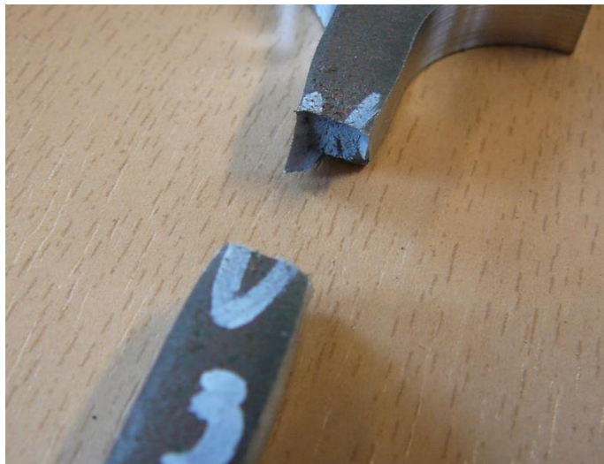
4.12. ábra. A V3 próbatest szakadási keresztmetszete (saját felvétel)
