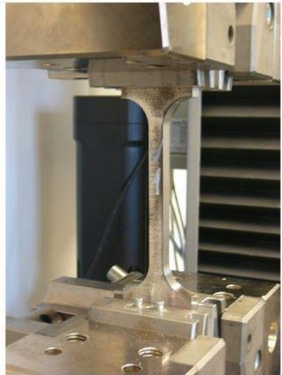
4.8. ábra. Az F1 és V1 próbatestek szakítás közben (saját felvétel)
