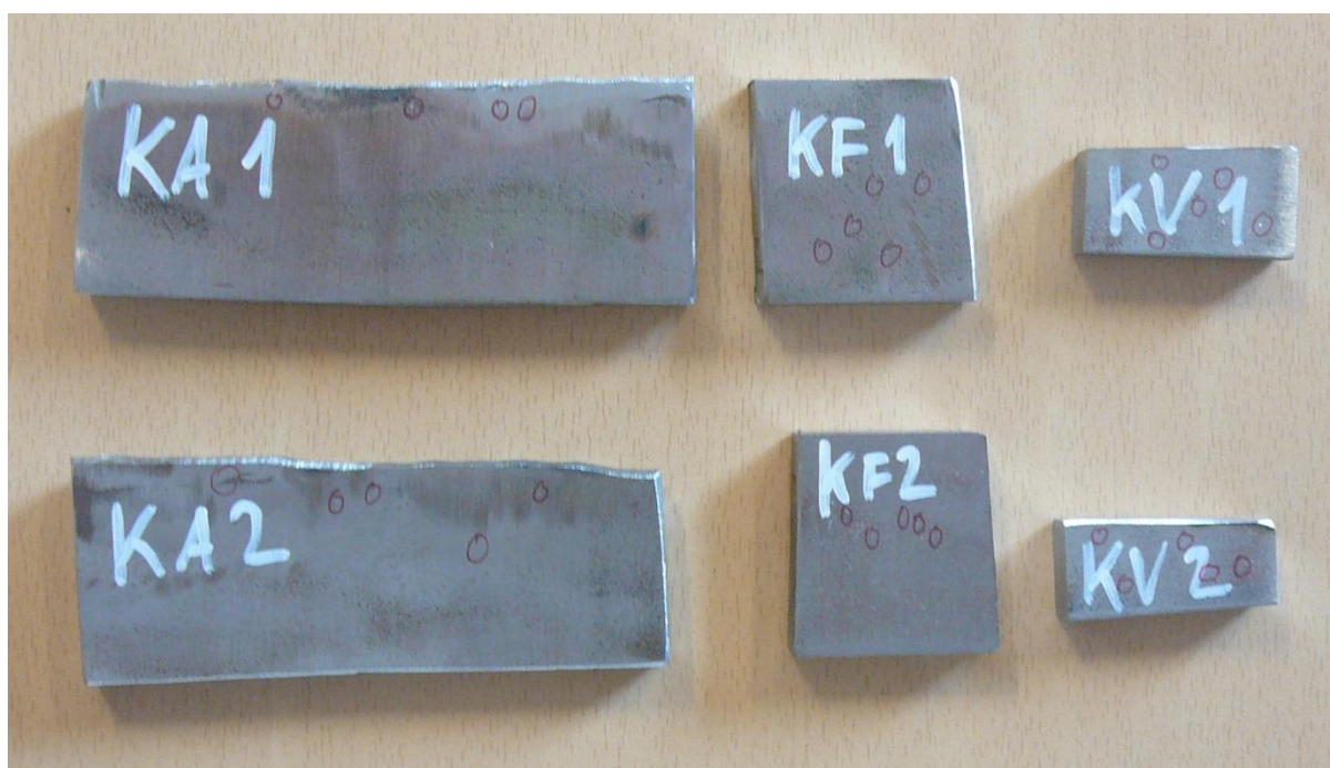
4.17. ábra. A próbatestek keménység mérése után (saját felvétel)
