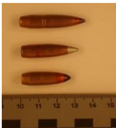
2.7. ábra. Lövedékek (fentről lefelé: B32; LPSZ; BZ) (saját felvétel)
