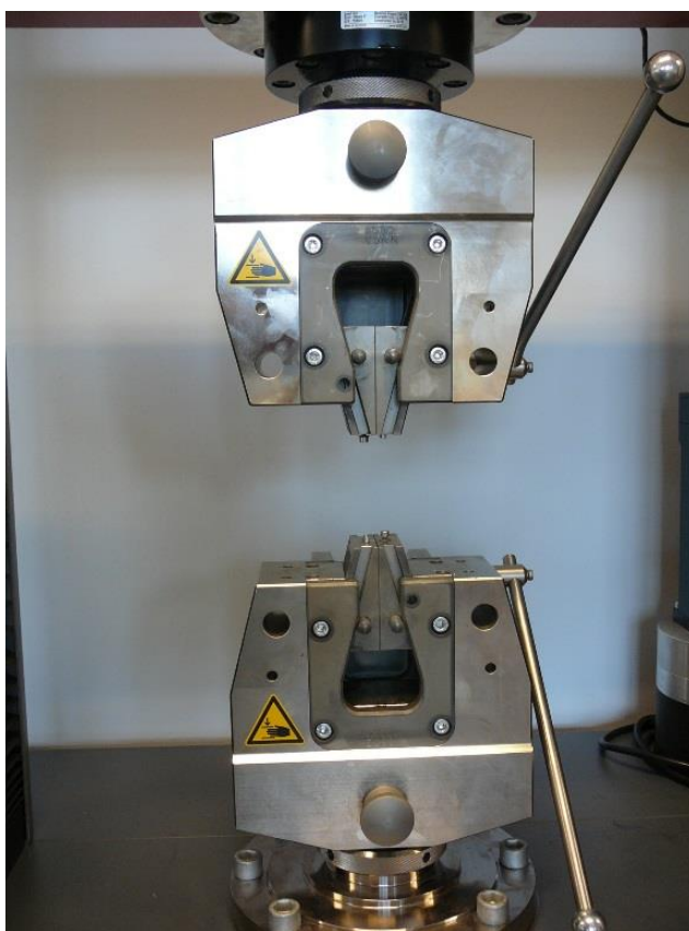
4.2. ábra. A mintadarabok befogása az anyagvizsgáló gépbe szabványos ékes szorítóval történt (saját felvétel)
