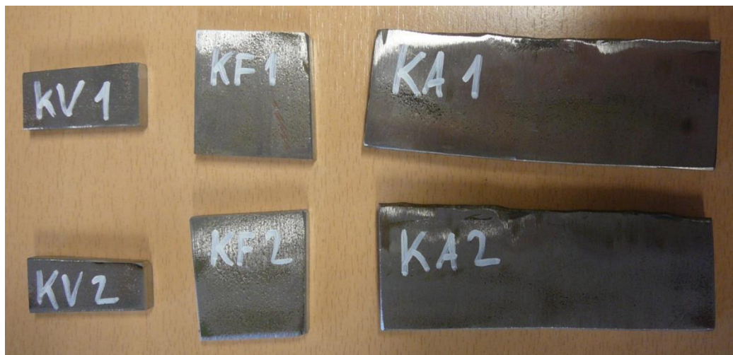
4.15. ábra. A keménységméréshez előkészített próbatestek (saját felvétel)
