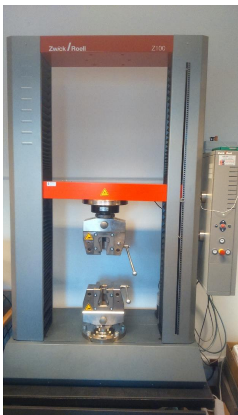
9. ábra Zwick/Roell Z100 szakítógép (saját kép)
