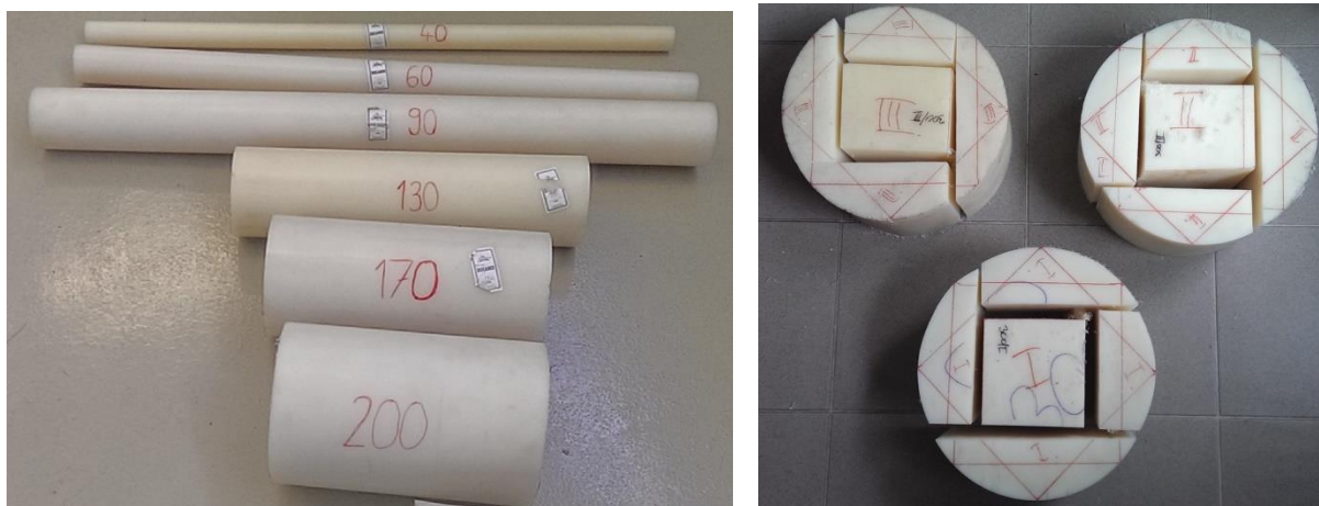
3.5. ábra. Próbatetek gyártására felhasznált öntött poliamid rudak
