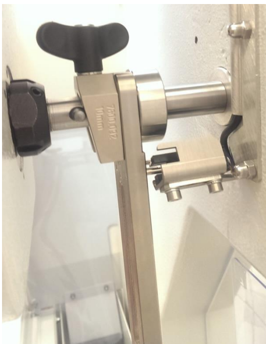
4.2.ábra. Kalapács rögzítése
