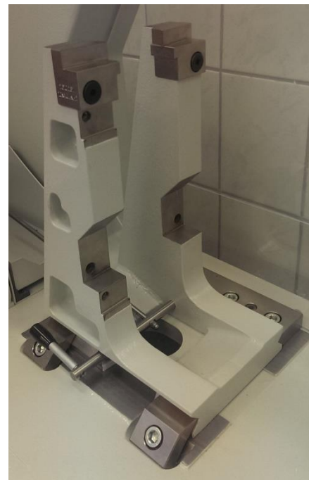
4.3. ábra. Rögzített üllő
