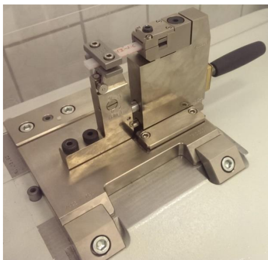
4.6. ábra. Ütve szakításhoz használt üllő befogott próbatesttel
