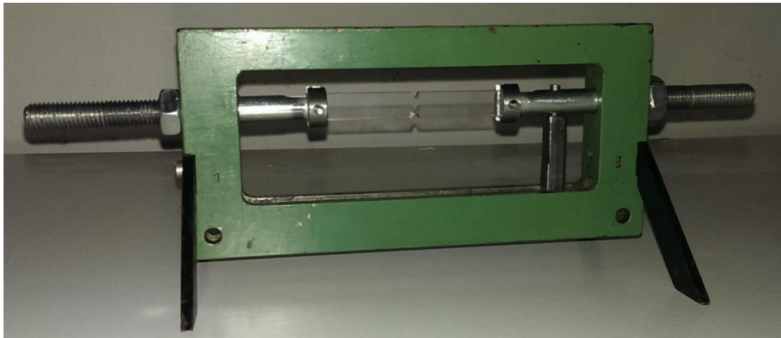
4.9. ábra. Húzásra alkalmas befogó keret
