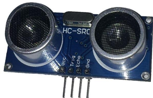
5. ábra: Felhasznált intelligens távolságmérő szenzor
