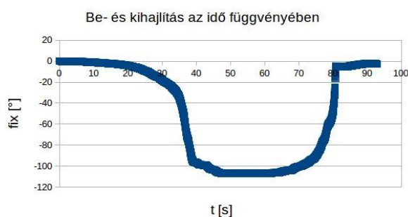
9. Ábra: Gumiizom modelles mérés
