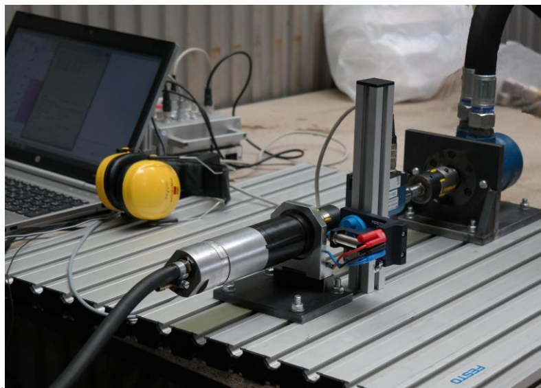
3-5. ábra 33ME720 légmotor mérése
