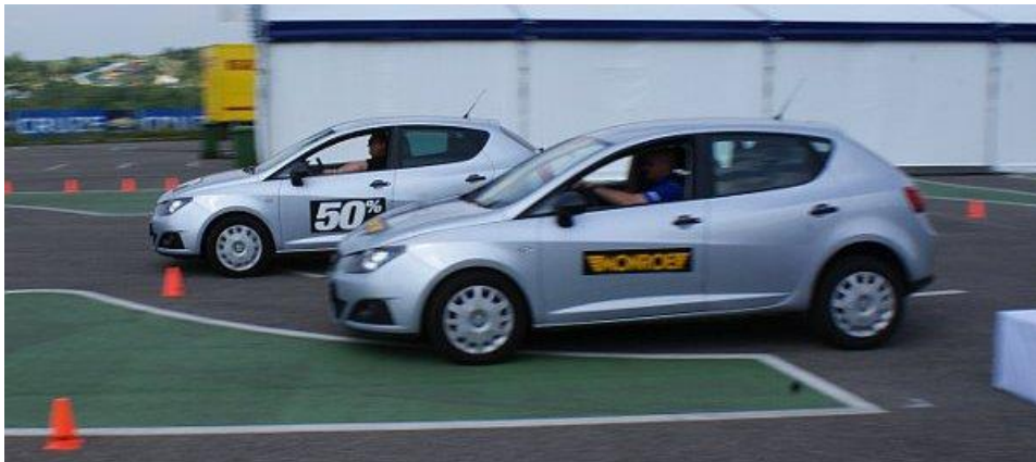
2.16. ábra: Egy 50%-os állapotú és egy új lengéscsillapító féktávolságok közötti különbség 1
