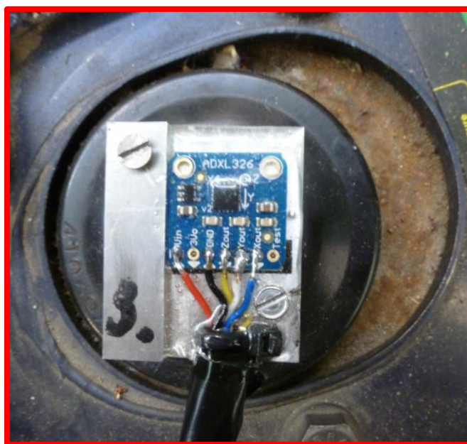
3.8. ábra: Felső gyorsulásérzékelő elhelyezése
