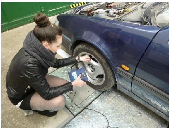
4.1. ábra: Guminyomás beállítása a mérések között
