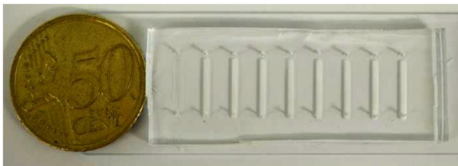
8. ábra: Kovalensen immobilizált tripszines mikroreaktor. A tripszin NH 2 -borított szilika tölteten van rögzítve. A párhuzamos tölteteken egyidejűleg több minta emésztése lehetséges. A folyadékok áramoltatása perisztaltikus pumpa segítségével történik. Áramlási sebesség a fehérjeminták emésztése során: 0,5 µl/min.
