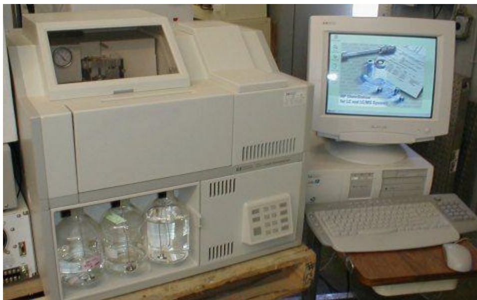
11. ábra: A analitikai és enzimes vizsgálatok során alkalmazott HPLC készülék
