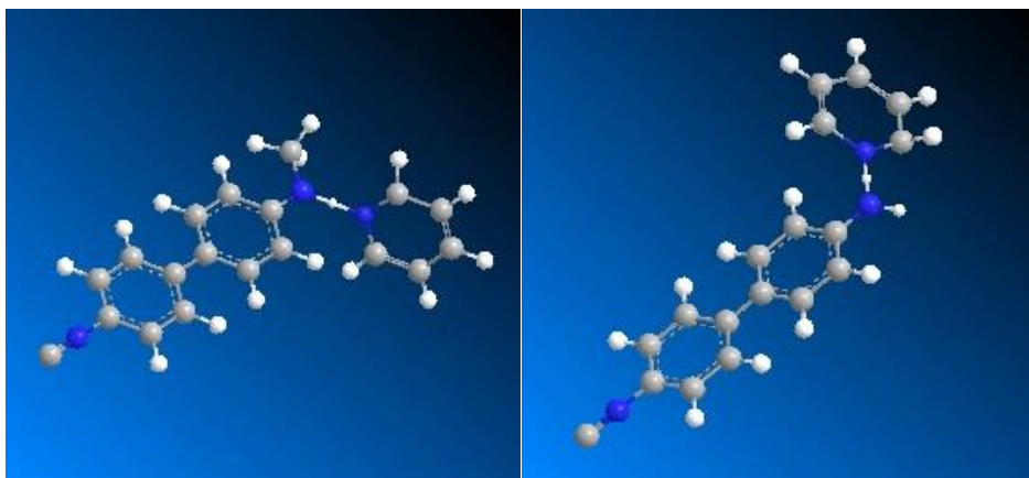
29. ábra: A monoMICAB és ICAB piridinnel képzett komplexeinek feltételezett szerkezete
