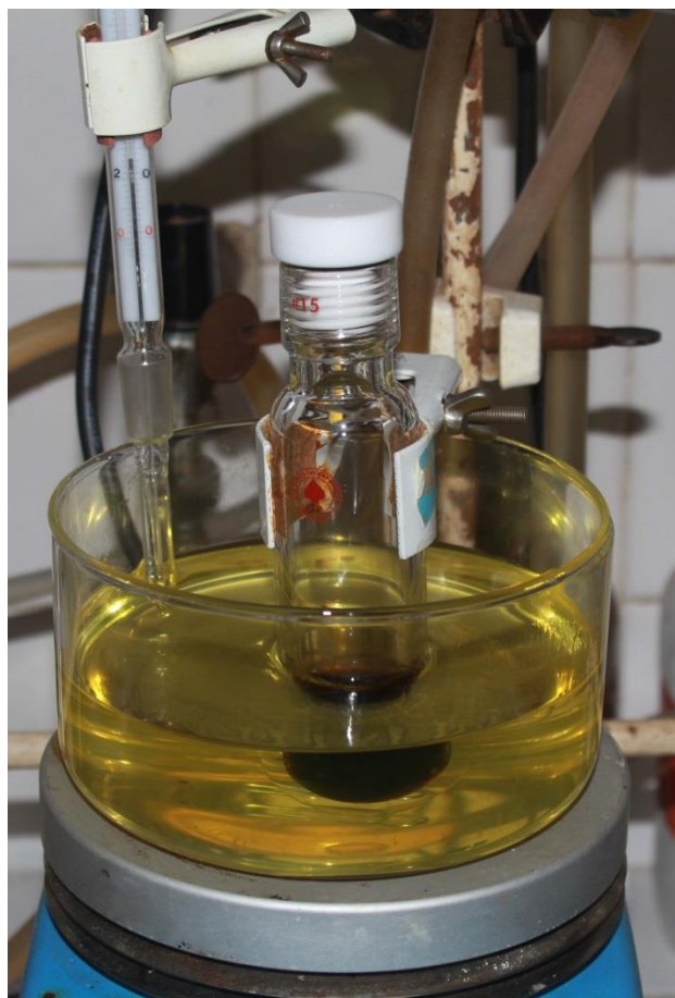
11. ábra: Az ICAB szintézishez használt kísérleti elrendezés, bombacsővel, olajfürdővel.
