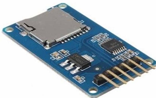
21. ábra SD kártya panel (a felhasználttal megegyező kapcsolású, de egy verzióval régebbi NYÁK kialakítású)
