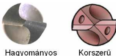
2.2. ábra. Hagományos és korszerű fúró élgeometria [2][13]
