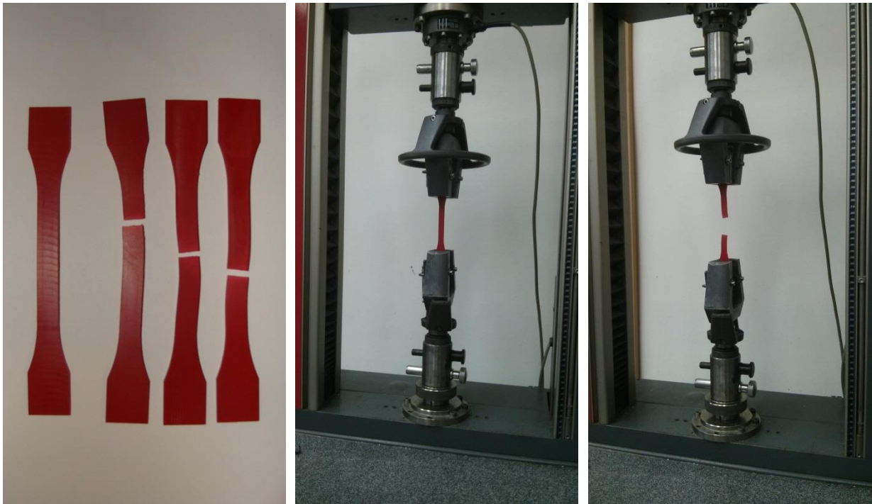
6. ábra: A próbatestek, és a szakítóvizsgálat menete
