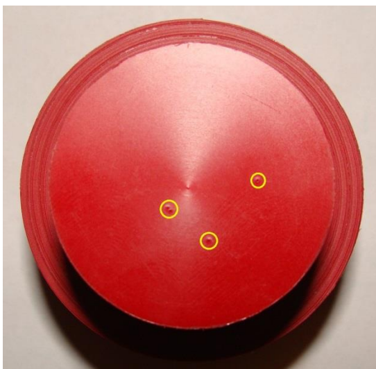
7. ábra A keménységméréshez használt próbatest, és a jelölt mérési pontok
