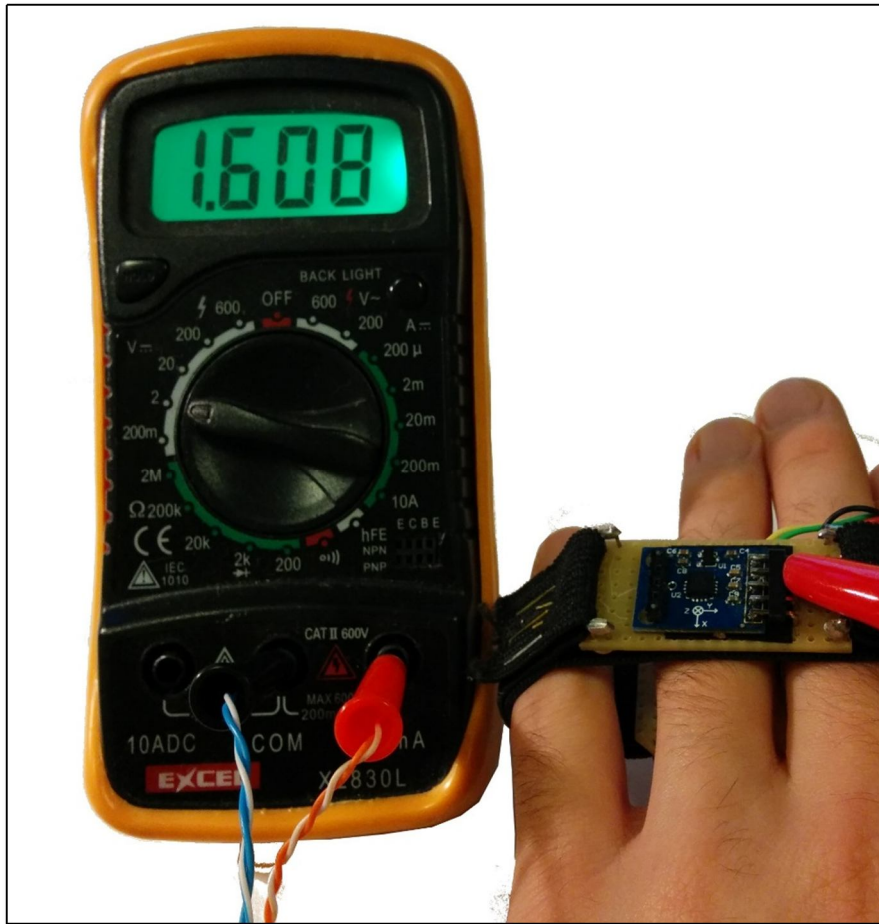
17. ábra Gyorsulásmérő kimeneti feszültségének mérési eredménye vízszintes helyzetben; forrás: szerző által készített ábra
