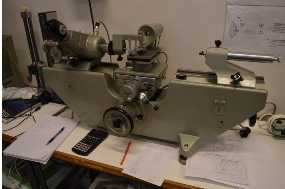
3. ábra: Zeiss ULM450 univerzális hosszmérőgép
