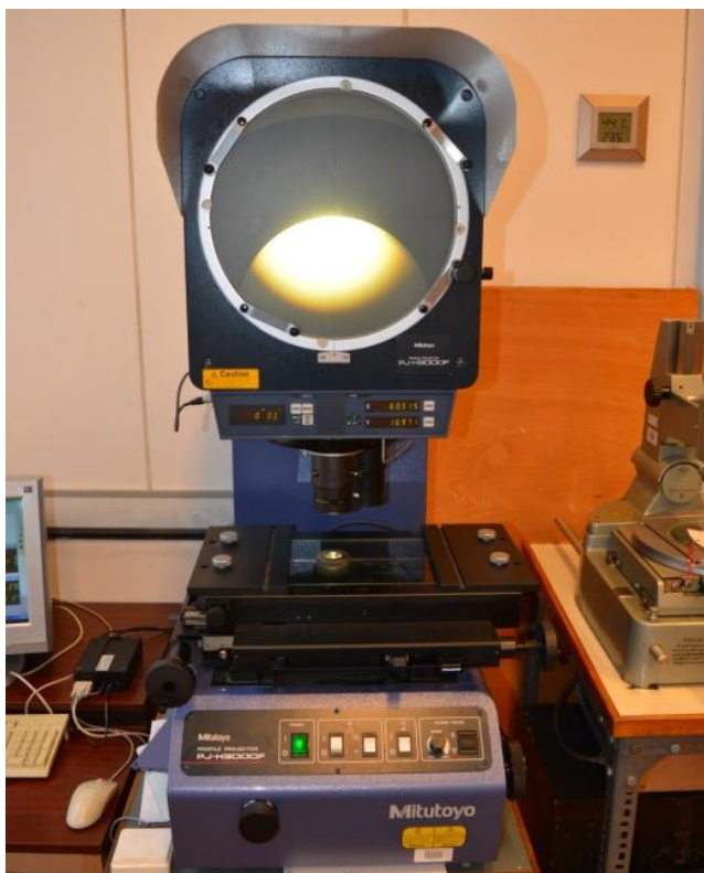
5. ábra: Mitutoyo PJ-H3000F profilprojektor
