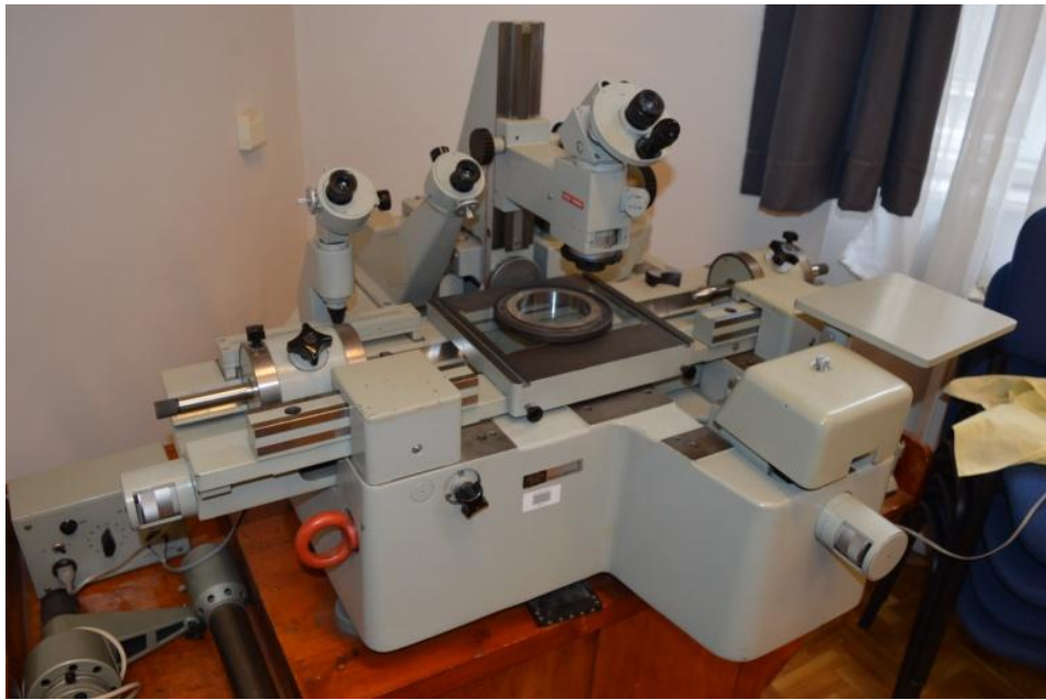
4. ábra: Zeiss egyetemes mikroszkóp
