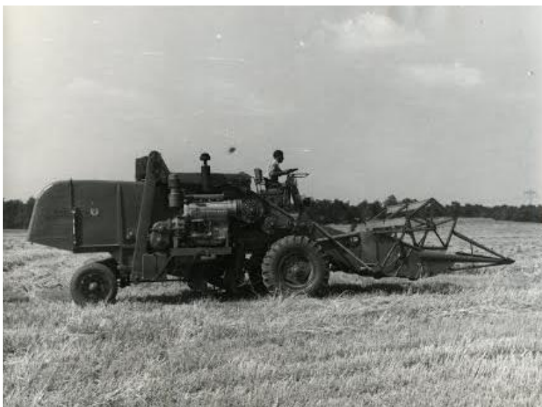
4. kép ZSMB-K nagyteljesítményű aratócséplőgép
