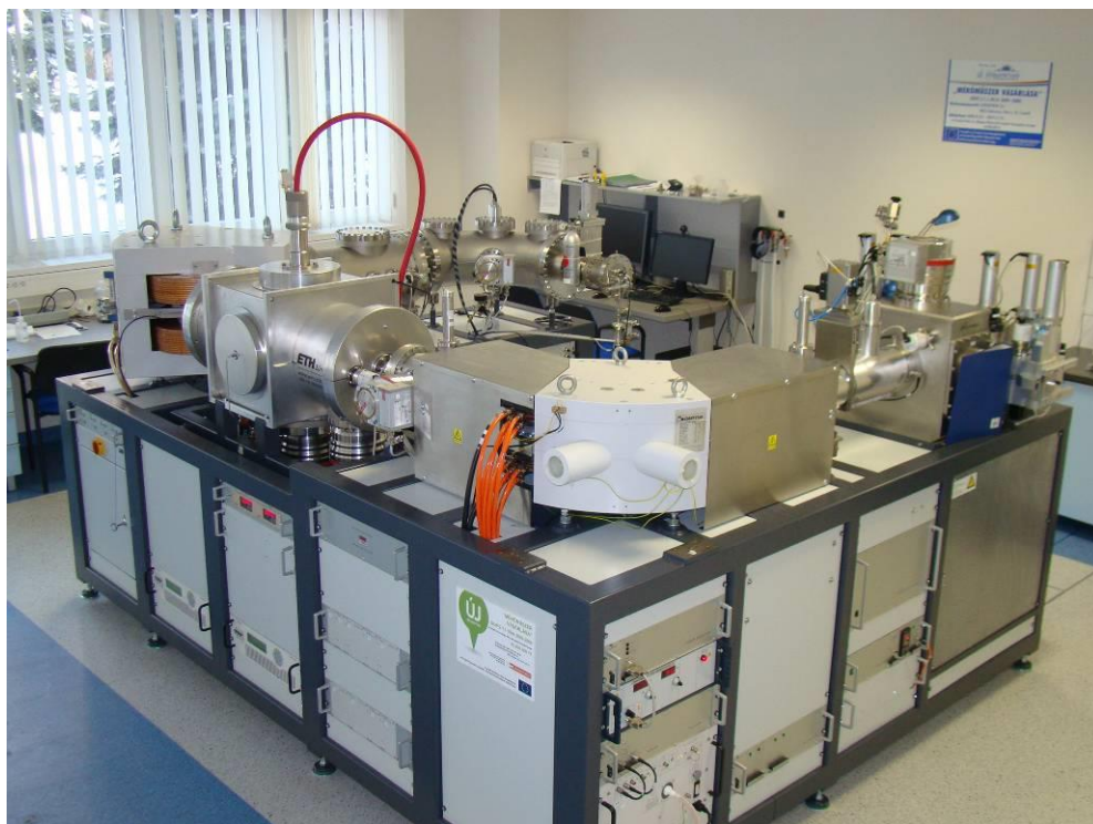
17. ábra: MICADAS ^{14}\text{C} AMS berendezés az ATOMKI-ban
