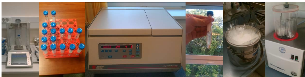
12. ábra: Az előkészítés egyes lépései (mérlegelés-centrifugálás-mosás-fagyasztás-liofilizálás)
