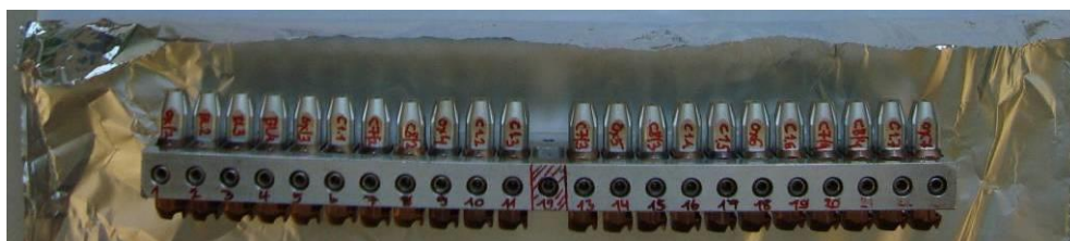
16. ábra: 22 db grafit targettel feltöltött mérési tár a MICADAS AMS 14C méréshez
