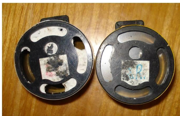
8. ábra. Példa a mérés során megrongálódott Radamon detektorokra
