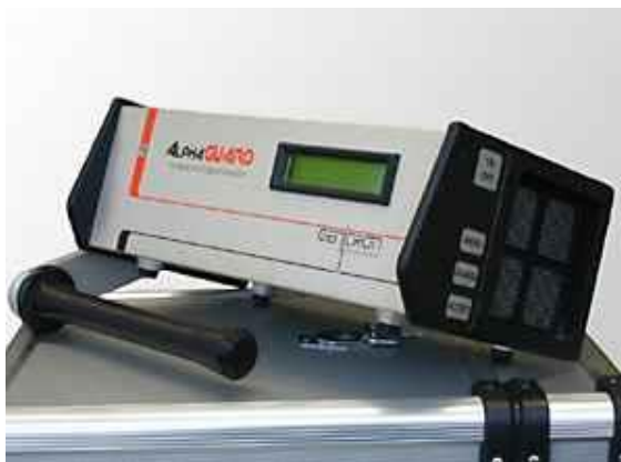
9. ábra. Az AlphaGuard ionizációs kamrás radonmérő műszer
