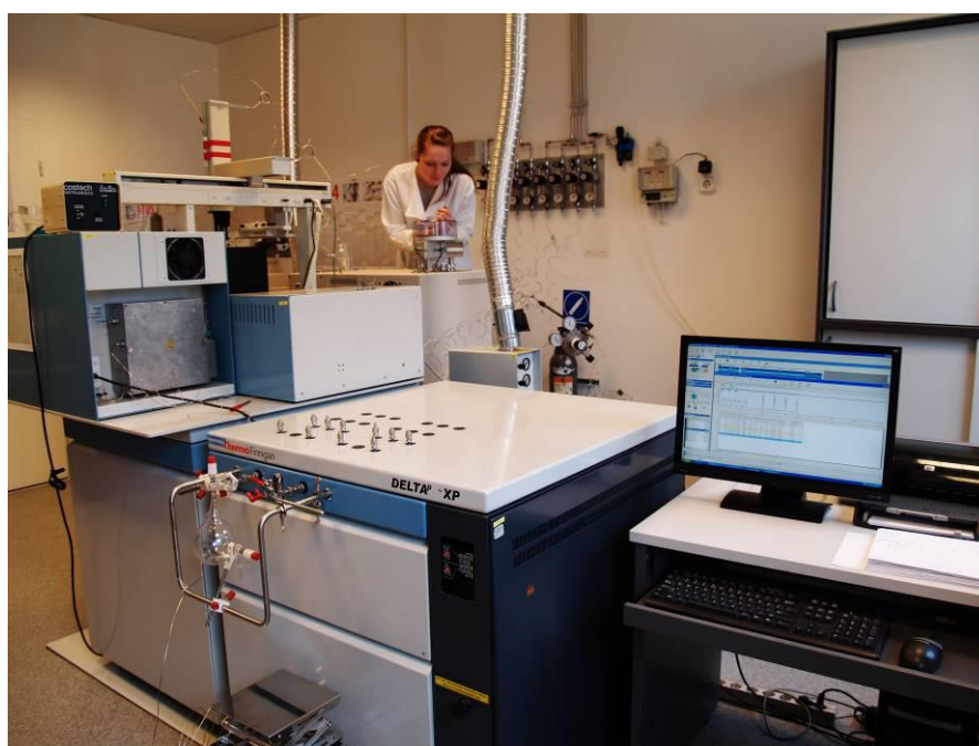
10. Ábra: A Delta + XP stabilizotóp-arány mérő tömegspektrométerhez kapcsolt Fisons elemanalizátor és a kiértékelő számítógép fényképe (fotó: Gyökös Brigitta)
