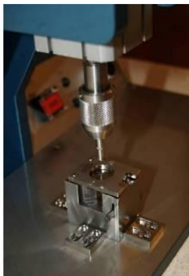
15. Ábra: Target előállítására alkalmas prés (forrás: ATOMKI)
