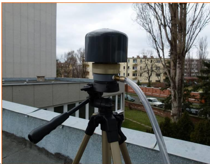
6. Ábra: Aeroszol mintavevőfej az ATOMKI épületének tetején
