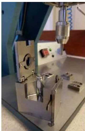
15. Ábra: Target előállítására alkalmas prés (forrás: ATOMKI)
