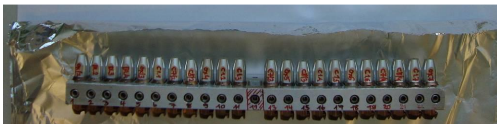
18. Ábra: 22 db grafit targettel feltöltött mérési tár a MICADAS AMS ^{14}\text{C} méréshez (forrás: ATOMKI)
