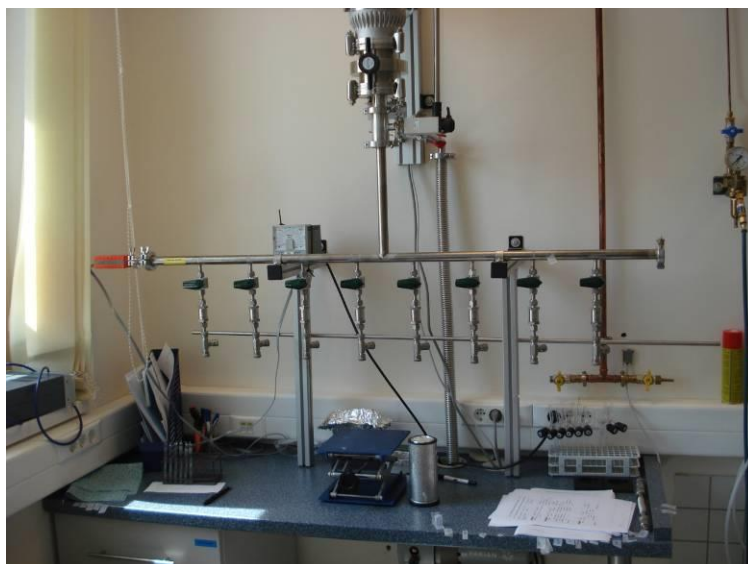
14. Ábra: Zártcsöves grafitizáló rendszer (forrás: ATOMKI)
