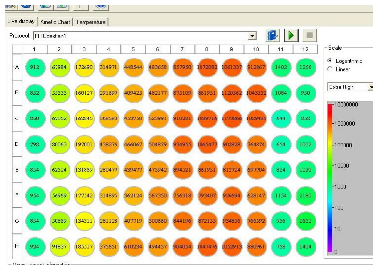
5. ábra A fluoriméter mérési adatainak megjelenítése FD4 mérések során. A kvantitatív méréseknél a megbízható méréstartomány 1000-500000 közötti fluoreszcencia intenzitás egységben definiált.
