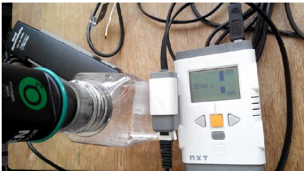
31. ábra Az oxigénmérő működés közben
