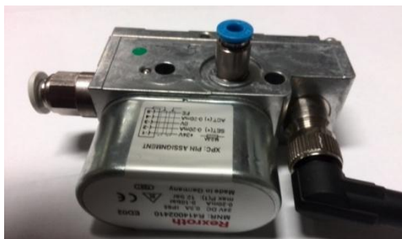
20. ábra: A felhasznált Rexroth pneumatikus nyomásszabályozó szelep
