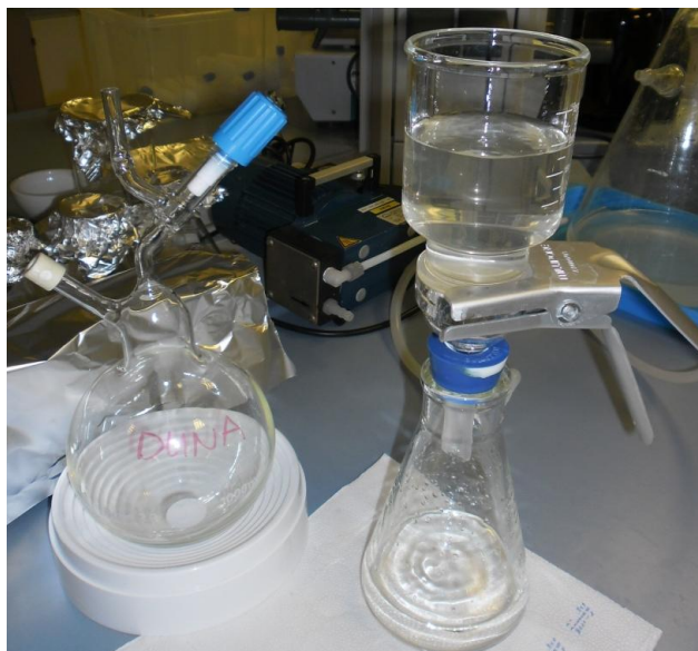
7. kép. Vízminta szűrése oldott NPO^{14}C preparálása előtt
