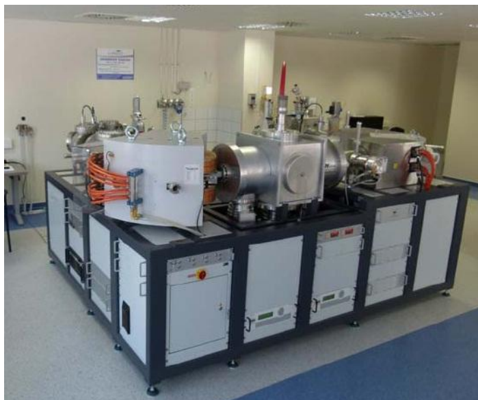
2.kép. MICADAS típusú AMS az ATOMKI- ban (forrás:ATOMKI-HEKAL)
