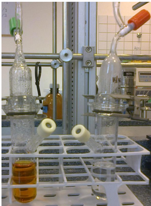
3-4 kép. Módszerfejlesztés a vízminták T^{14}C feltárására. Bal oldalon a korábbi T^{14}C feltárás eszközei, jobb oldalon az új ampulla és alkalmazása
