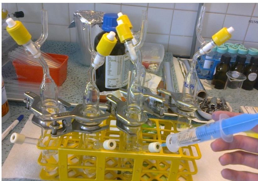
5. kép. Oldott szervesetlen szénfrakció feltárása
