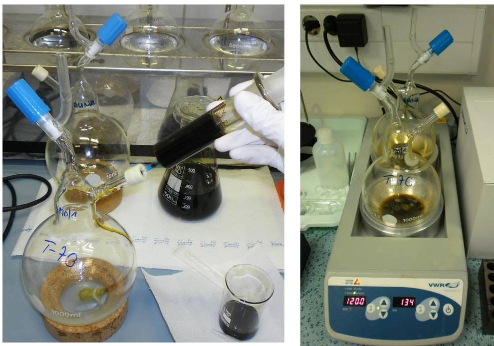
8-9.kép. Oxidálószer adagolása és a minta fűtése
