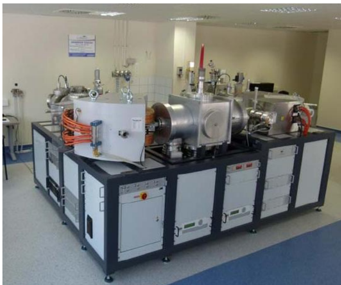
4.kép. MICADAS típusú AMS az ATOMKI- ban (forrás:ATOMKI-HEKAL)
