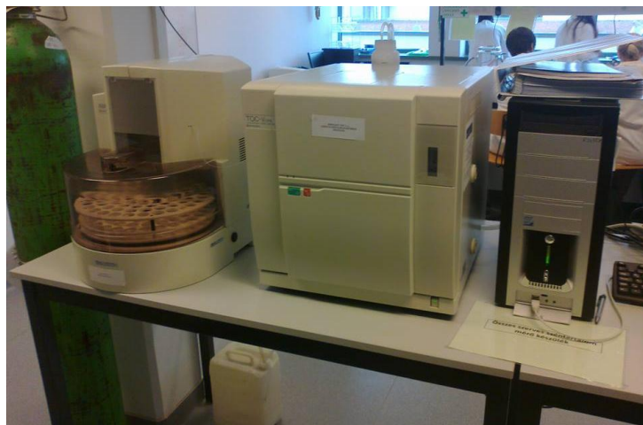
3. kép. Shimadzu TOC-V CPN készülék
