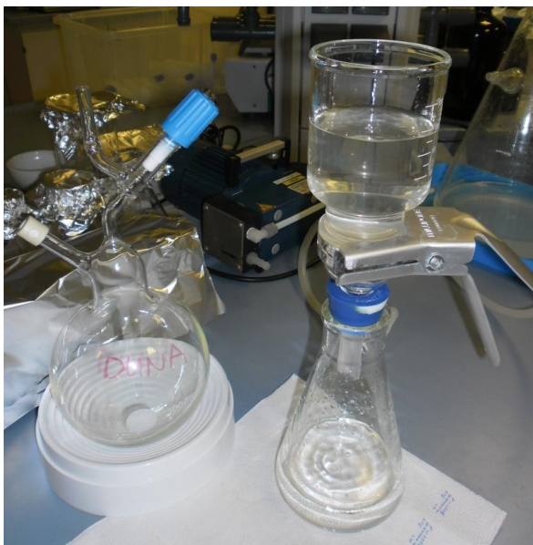
9. kép. Vízminta szűrése oldott \text{NPO}^{14}\text{C} preparálása előtt
