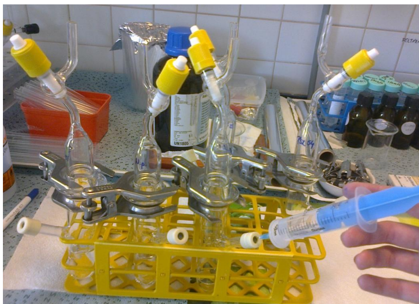
7. kép. Oldott szervesetlen szénfrakció feltárása
