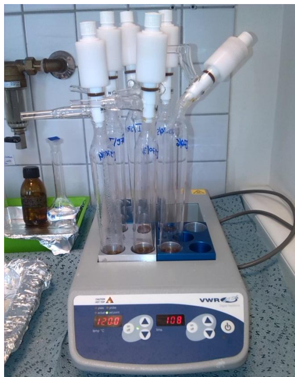
5-6.kép. Módszerfejlesztés a vízminták T^{14}C feltárására. Bal oldalon a korábbi T^{14}C feltárás eszközei, jobb oldalon az új ampulla és alkalmazása
