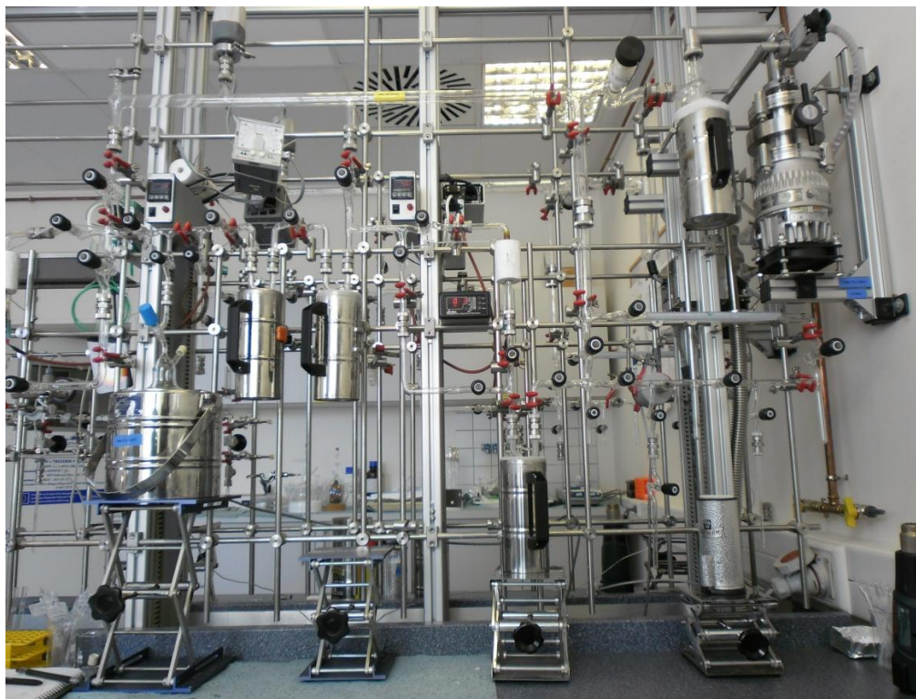
14. kép. AMS feltáró rendszer
