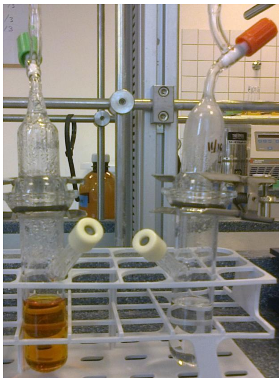
5-6.kép. Módszerfejlesztés a vízminták T^{14}C feltárására. Bal oldalon a korábbi T^{14}C feltárás eszközei, jobb oldalon az új ampulla és alkalmazása
