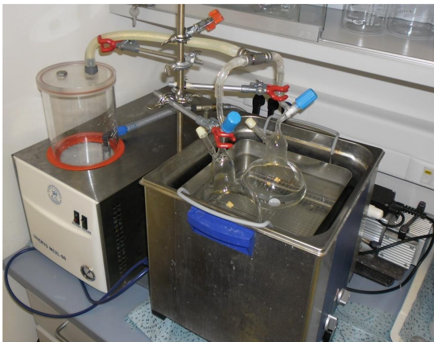
10. kép. Bepárló és vákuumdesztilláló rendszer
