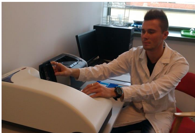
6. ábra: Malvern Zetasizer NanoZ készülék Debreceni Egyetem Műszaki Kar Környezet- és Vegyészmérnöki Tanszék Vízhatalóságvédelmi Laboratórium
