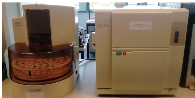
9. ábra Shimadzu TOC-V CPN készülék
