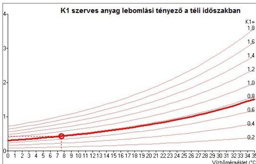
31. ábra A K_1 szerves anyag lebomlási tényező becslése a hőmérséklet függvényében
