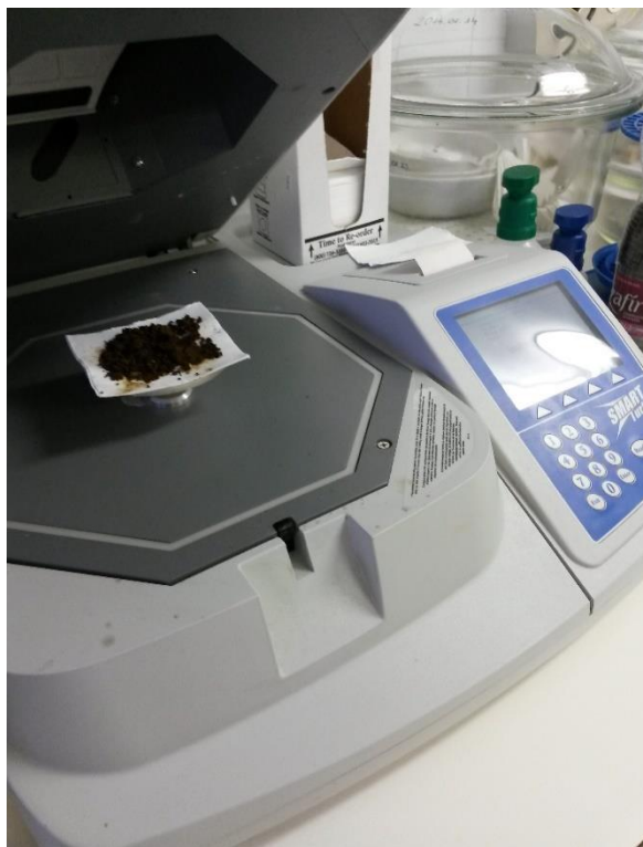
17. kép: Szárazanyag vizsgálat a laboratóriumban (2014. 10. 16.)
