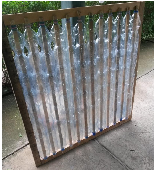
8. kép: PET palackokból létrehozott váz-eleme az iszapszárítónak (2014. 08.07.)
