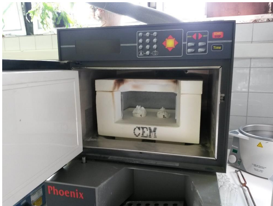
18. kép: Izzítás a szervesanyag-tartalom meghatározására (2014. 10. 16.)
