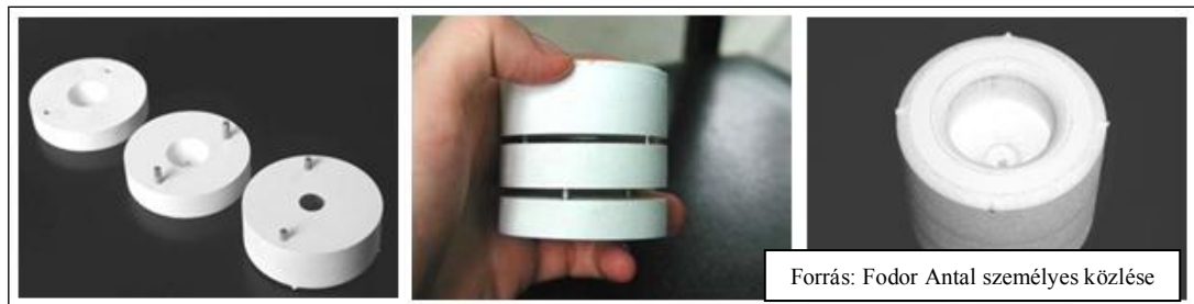
1. ábra - Szeletelő marással készült darab összeszerelése
