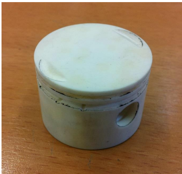
9. ábra. A kész kerámia dugattyú
