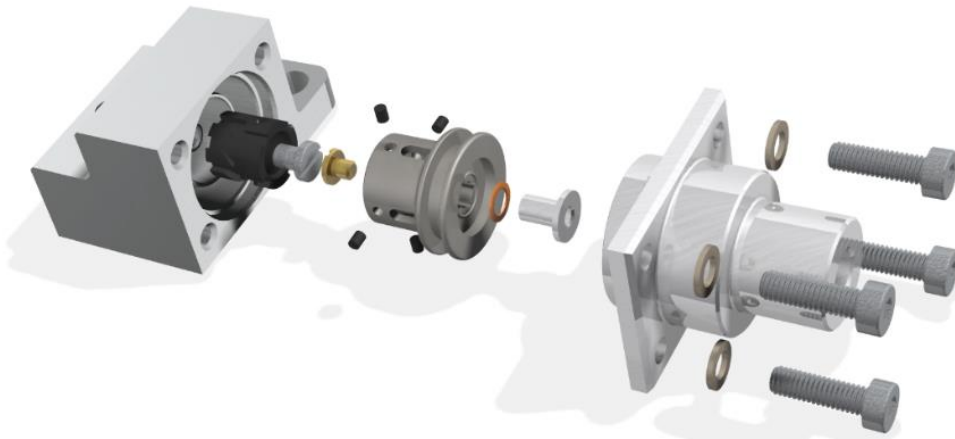
4. ábra. A szelep robbantott ábrájának bemutatása
