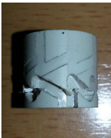
54. ábra. Hibás szerszámsugár-korrektció "Z" irányban
