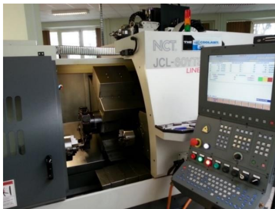
5. ábra. Azt eddigi gyártás az NCT JCL-60YTSM típusú ellenorsós esztergagépen történt
