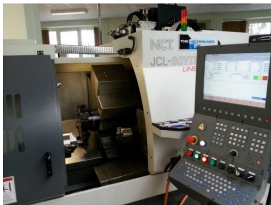
5. ábra. Azt eddigi gyártás az NCT JCL-60YTSM típusú ellenorsós esztergagépen történt
