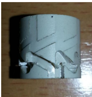
54. ábra. Hibás szerszámsugár-korrektció "Z" irányban
