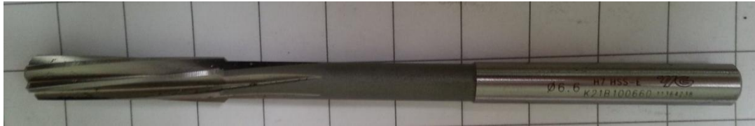
17. ábra. Ø6,6H7 Gépi dörzsár YG K21B100660 H7 HSS-E
