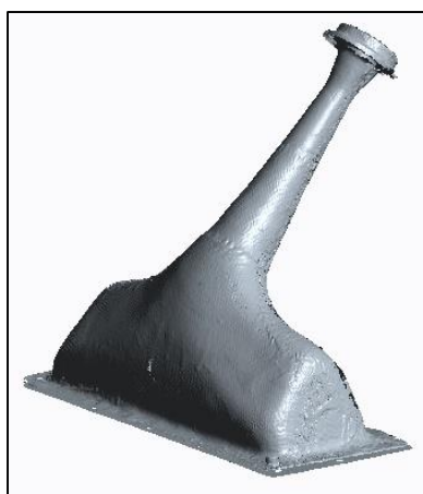
15. ábra Régi airbox felső részének pontfelhője
