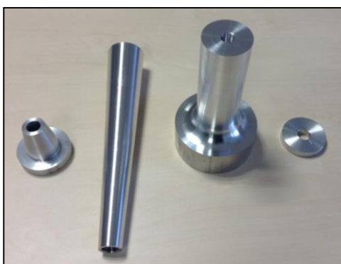
55. ábra Perunál alumíniumból esztergált csőhossz és tütte szerszám
