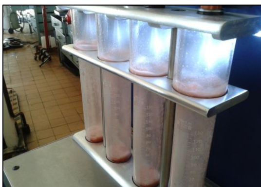
25. ábra Yamaha befecskendezők a vizsgálópadon
