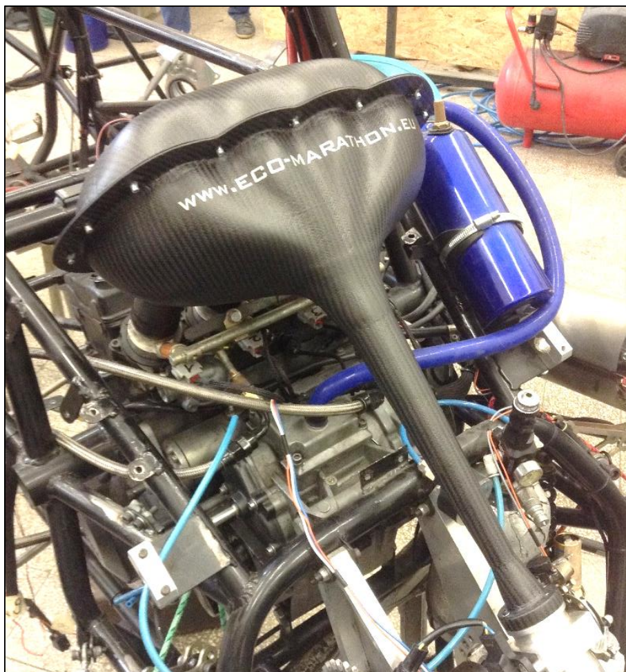
54. ábra Az új airbox a versenyautóba beépítve
