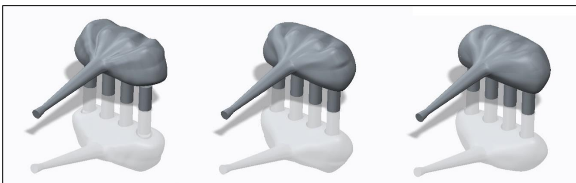
59. ábra Az airbox topológiai evolúciója
