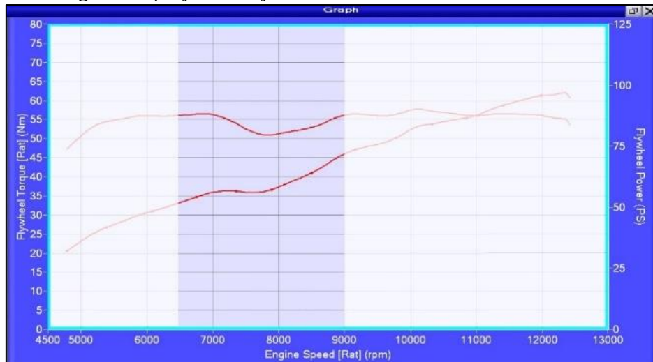
65. ábra Görgős fékpádon mért nyomaték és teljesítmény karakterisztika (régi airbox) [KEFO Motorsport]
