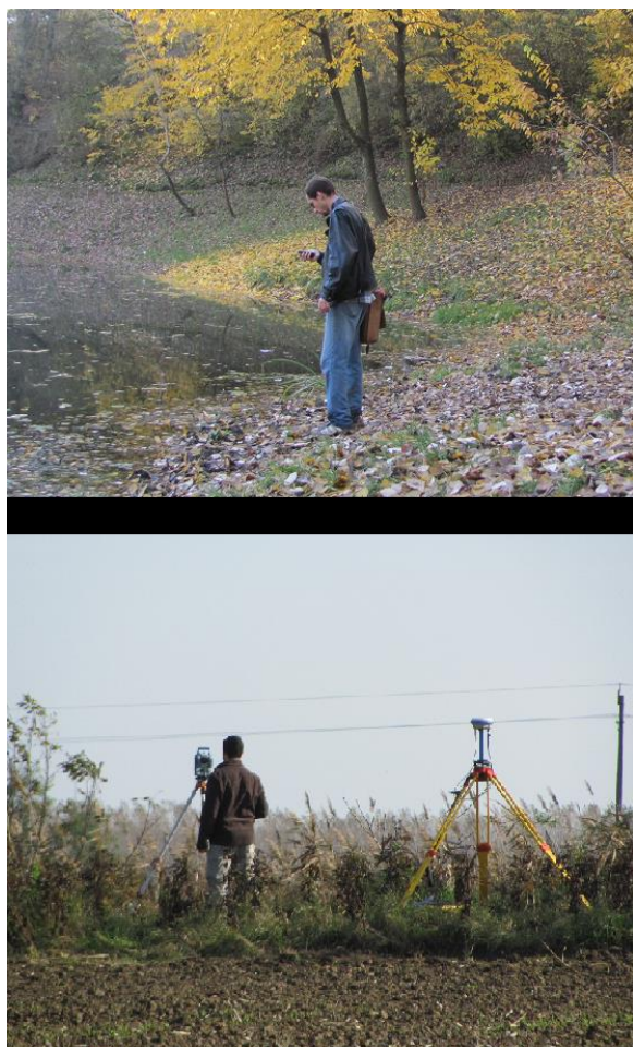
4.2. kép: Geodéziai mérések a terepen. Fent: a barometrikus Garmin GPS-szel. Lent: a háttér-ben a Focus8 mérőállomás, előtérben pedig a Stonex nevű műszer bázisállomása.
