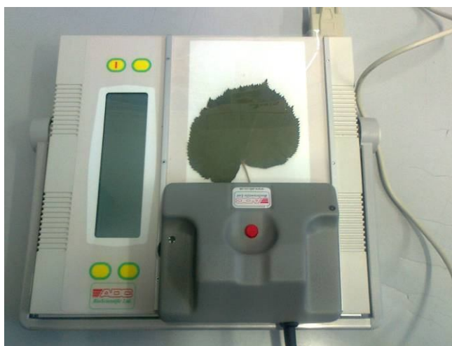
27. ábra: A levelek felületének méréséhez használt AM350 típusú levélszkennerr (Fotó: Steiner Márk, 2014.)
