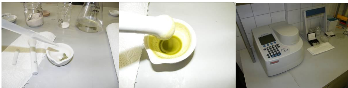
28-30. ábra: A klorofillméréshez történő előkészítés és a spektrofotométer (Saját felvételek, 2014.)
