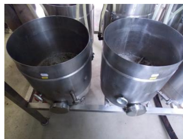
14. kép: Mustülepítés hűtőköpenyes acéltartályokban
