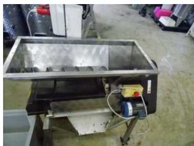
12. kép: A szőlő feldolgozásához használt bogyózó-zúzó (Fotók: Ember)
