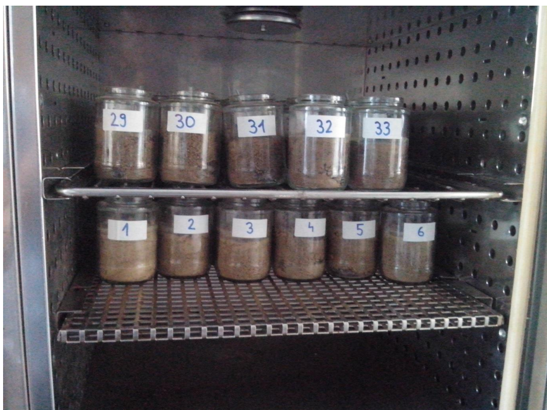
9. ábra: A talajminták a termosztátban forrás: saját fotó
