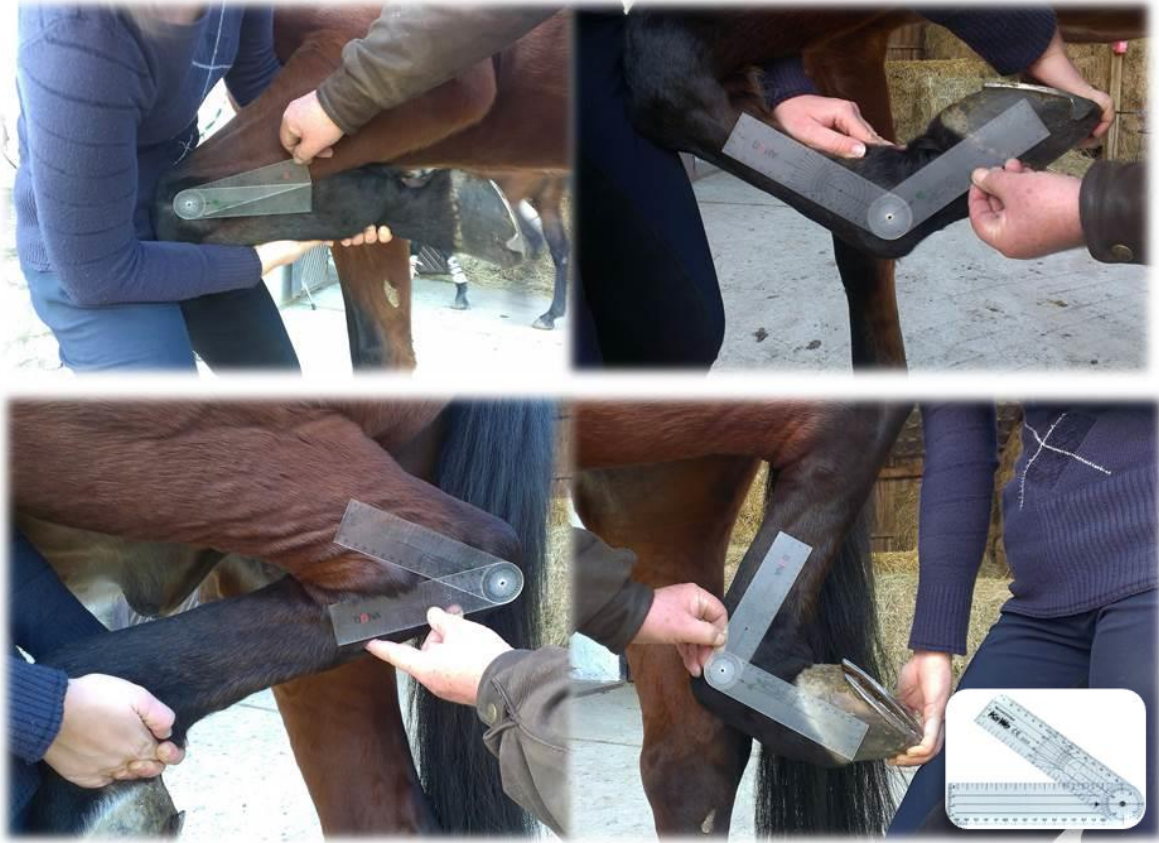
17.kép: : Ízületek maximális hajlíthatóságának mérése
