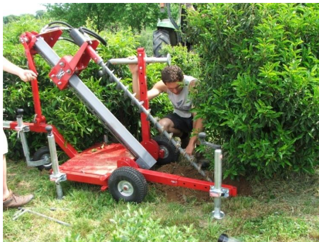
7. ábra: Műanyag csövek telepítése a gyökérzónába
