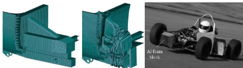
6. ábra Egy gépkocsi fémhab karosszéria elemének roncsolódása baleset esetén, illetve egy versenyautó ütközője [30-31]
