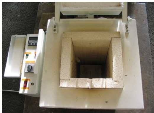
1. ábra Hőker típusú olvasztó kemence [1]
