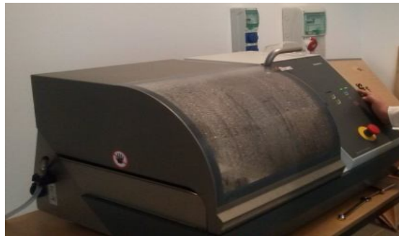
23. ábra Fémhab próbatestek méretre vágása [Forrás: saját készítés]
