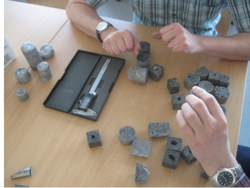
21. ábra Fémhabok kiválogatása a vizsgálatához [Forrás: saját készítés]
