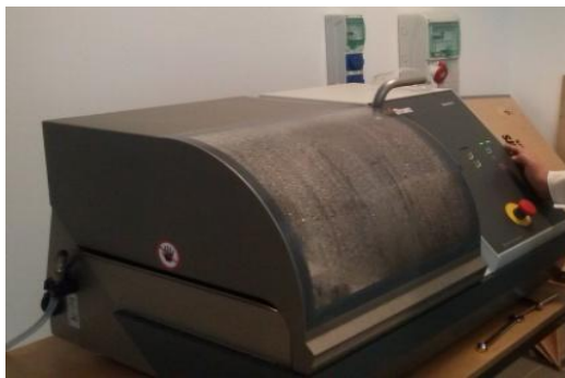
23. ábra Fémhab próbatestek méretre vágása [Forrás: saját készítés]
