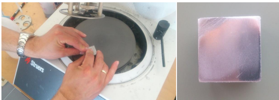
12. ábra A fémhab alapanyagának polírozása és a polírozott munkadarab
