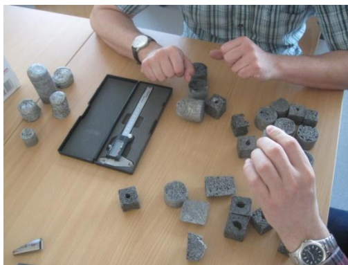
21. ábra Fémhabok kiválogatása a vizsgálathoz [Forrás: saját készítés]
