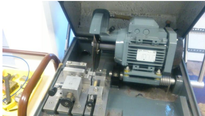
18. ábra Próbatestek méretre vágása [Forrás: saját készítés]
