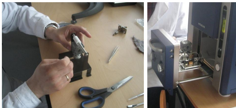
14. ábra A minta előkészítése és a gépbe helyezett fémhab látható
