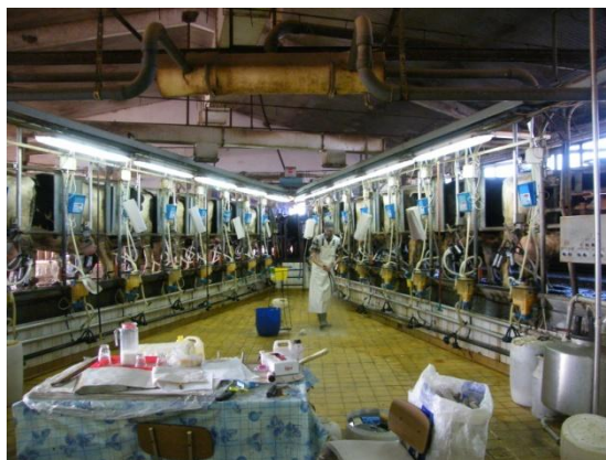
2.kép: 4x8-as polygon elrendezésű fejőház a gorzsa telepen
