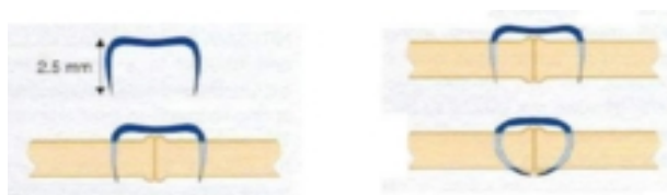
6. ábra Törött csontok rögzítése nitinol huzallal [10]
