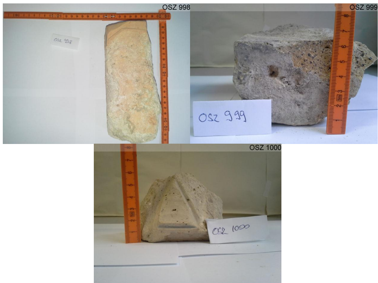
3. ábra: meggyújtott minták, OSZ 999 fúrással, OSZ 996, 997, 998, 1000 reszelővel
